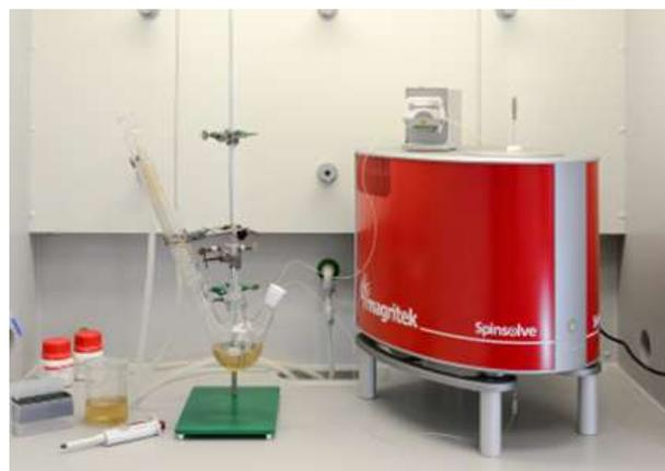
Спектрометр Magritek Spinsolve в конфигурации для он-лайн мониторинга химических реакций; установлен в вытяжном шкафу
